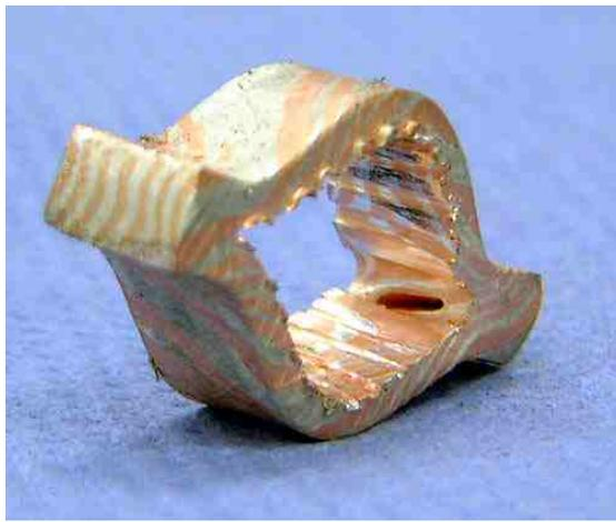
das zwischenglühen nicht vergessen. sonst entsteht sehr schnell ein spalt, wie auf dem bild zu erkennen ist.
