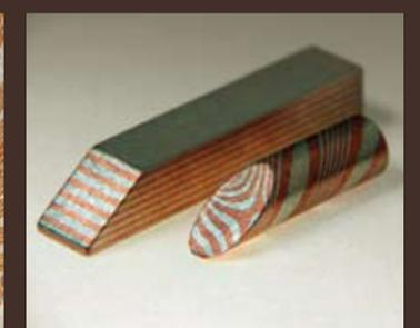
Beispiele für Schichtmetalle von Schichtwerk, wie sie auch in den Bibliotheken von Material ConneXion zu finden sind. Anwendungsmöglichkeiten sind: Schmuck, Gefäße, Uhrengehäuse, Schreibgeräte und Brillengestelle
